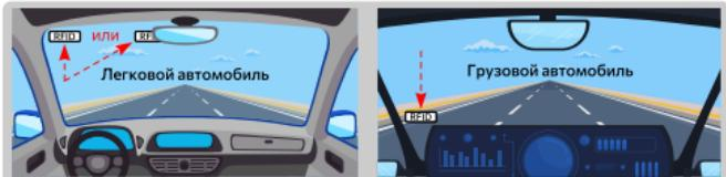
Более предпочтительным является расположение в левом верхнем углу лобового стекла (для легковых, для грузовых - левый нижний). Оптимальная высота расположения относительно проезжей части - 1,45 - 1,5 метра (для легковых автомобилей);
